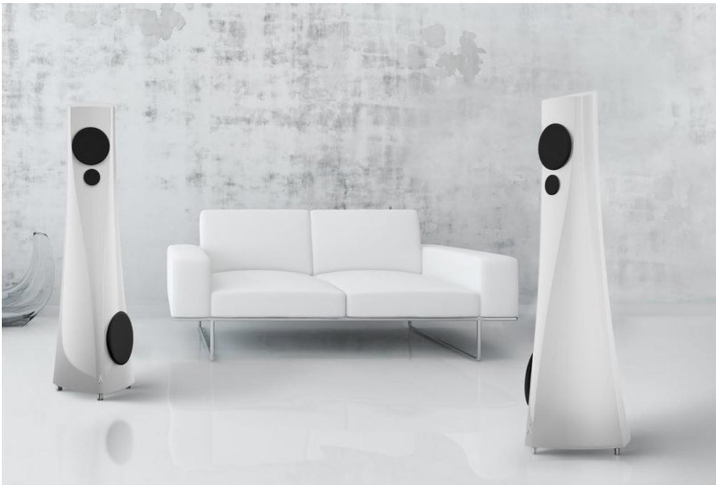
Para baratear os custos, a YB MKII utiliza um woofer de 8 polegadas da SEAS com cone de alumínio, um falante de médio de 5,8 polegadas da Scanspeak com o famoso cone de papel deste fabricante, da série Revelator, e um tweeter de 1 polegada também Scanspeak de cúpula de berílio, da série Illuminator. A fiação interna é agora a mesma utilizada na série Diamond, da Kubala-Sosna.
