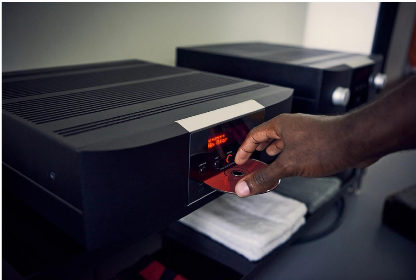
Ele é montado contra choque, em uma unidade de aço, com uma blindagem para redução de ruído elétrico e mecânico. Basta encostar o CD para ele ser 'sugado' de maneira segura e com baixo ruído operacional.
