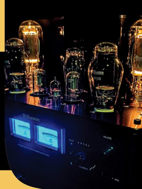
**Willsenton R8** KT88/EL34 : Um amplificador que poderá ser utilizado com válvulas EL34, KT88 ou 6550 conseguindo-se, assim , obter 3 tipos de sonoridade distinta sem a necessidade de troca de aparelho .
