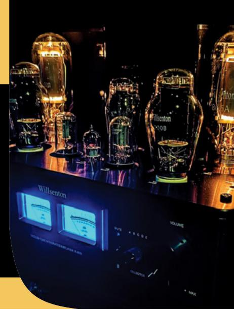
**Willsenton R8** KT88/EL34 : Um amplificador que poderá ser utilizado com válvulas EL34, KT88 ou 6550 conseguindo-se, assim , obter 3 tipos de sonoridade distinta sem a necessidade de troca de aparelho .
